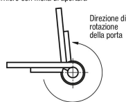
Cerniere con molla di apertura
