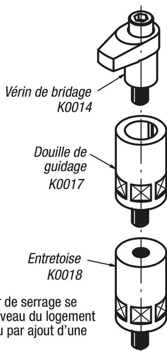
La hauteur de serrage se règle au niveau du logement du vérin ou par ajout d'une entretoise.
